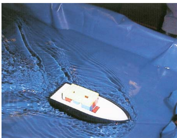
Figur 1. Skibet trækkes vandret af en tråd gennem en trisse op til en anden trisse hvorover tråden fører til et faldende lod. Tophastigheden bestemmes ved hjælp af en tænketrisse (Smart Pulley). Vandkarret står på et bord og er fremstillet af spånplade og en havepressenning. Man måler tophastigheden ved belastning med forskellige lodder. Kamilla, Karen, Camilla og Line 2.g.
