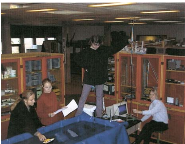
Figur 1. Skibet trækkes vandret af en tråd gennem en trisse op til en anden trisse hvorover tråden fører til et faldende lod. Tophastigheden bestemmes ved hjælp af en tænketrisse (Smart Pulley). Vandkarret står på et bord og er fremstillet af spånplade og en havepressenning. Man måler tophastigheden ved belastning med forskellige lodder. Kamilla, Karen, Camilla og Line 2.g.
