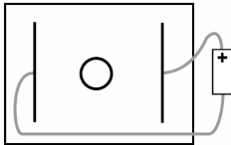
Figur 10a: Rammen er ikke en elektrode, men papirets kant. Før den cirkulære elektrode tegnes findes ækvipotentialkurver for de to retlinjede elektroder. Tegn den cirkulære elektrode og find igen ækvipotentialer. På hvilken måde forvrænger den cirkulære elektrode feltet?
